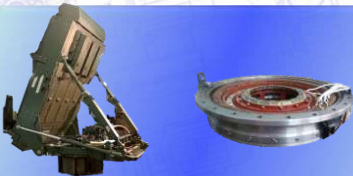
Привод опорно-поворотного устройства РЛС
